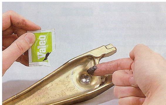
Λίπανση βραχίονα μηχανισμού απενεργοποίησης συμπλέκτη
