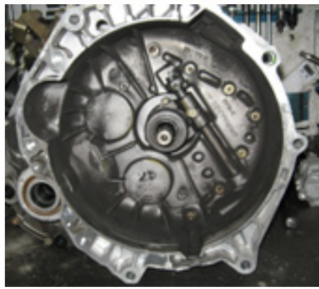
Σασμάν Mini, πρωτεύον άξονας, ρουλεμάν και δίχαλο
