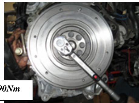
Τελική σύσφιξη βολάν με ροπή 90Nm
