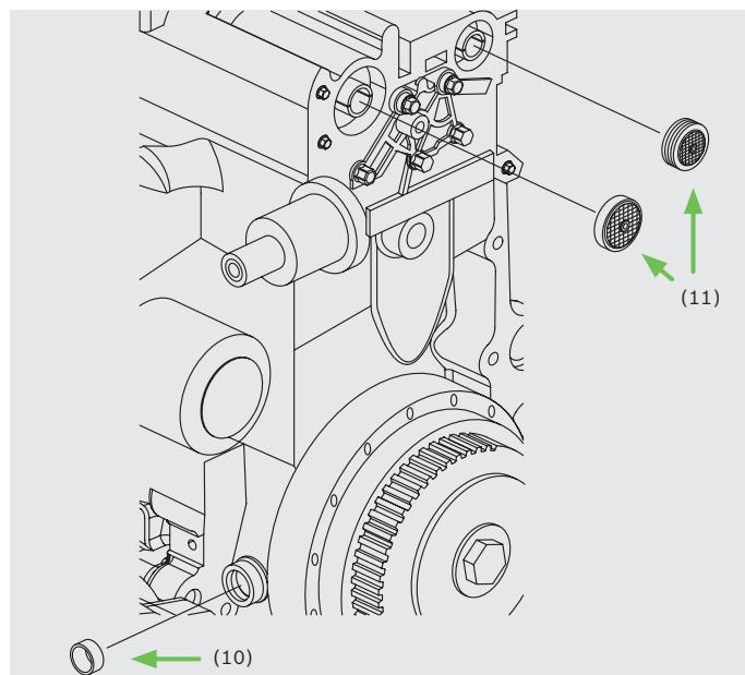
Bei der Montage des neuen Zahnriemenkits sind bei einigen Fahrzeugmodellen auch die Nockenwellenräder zu lösen. Diese Teile für die Nockenwellenräder liegen den Kits nicht bei, sie sind vom Fahrzeugherrsteller zu beziehen.
