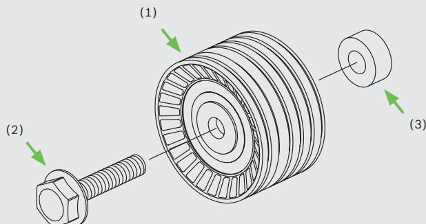
Die Umlenkrolle (1) hat ein neues Abdichtungskonzept und kann sich daher von der ausgebauten Umlenkrolle unterscheiden.
