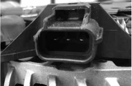
▶ Is de 3-pins aansluitkabel naar de generator beschadigd (werkend stekker, kabelbreuk, beschadigde isolatie etc.)? Vaak wordt vastgesteld dat deze kabels in de buurt van de generator beschadigd zijn. In dat geval moet deze kabel worden vervangen!
