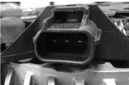
▶ Det 3-polede tilslutningskabel til generatoren beskadiget (stikkets funktion, brud på kablet, beskadiget isolering osv.)? Det er ofte sådan, at disse ledninger er beskadiget i nærheden af generatoren. I dette tilfælde skal kablet udskiftes!
