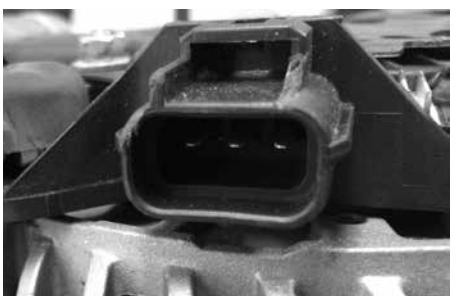
▶ Je třípolový připojovací kabel ke generátoru nepoškozený (funkčnost zástrčky, přerušení kabelu, poškozená izolace, atd.)? Často zjištějeme, že toto vedení je v blízkosti generátoru poškozeno. V takovém případě se musí tento kabel vyměnit!
