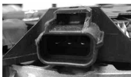
▶ Il cavo di collegamento tripolare all'alternatore non è danneggiato (Funzionamento spina, rottura del cavo, isolamento danneggiato, ecc.)? Spesso va constatato che questi cavi mostrano segni di danni in prossimità dell'alternatore. In tal caso, il cavo deve essere sostituito!
