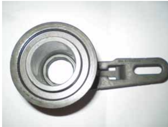
Рис. 2 Новый узел натяжного ролика Заданное положение натяжения (1)
