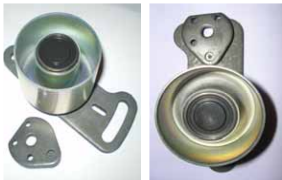
Рис. 2 Новый натяжной ролик с пластиной
