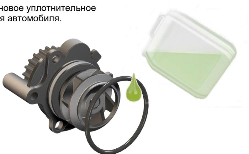
Если требуется использовать герметик, то использование никаких других уплотнителей не допускается. Убедитесь в том, что герметик нанесен правильно. Как в примере, показанном здесь, заполните канавку каплями толщиной 3-4 мм.
