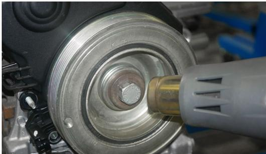
A continuación, afloje el tornillo. Si la resistencia es excesiva, vuelva a enroscar un poco el tornillo y caliéntelo de nuevo con cuidado.
