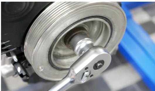
Una vez desenroscado el tornillo, limpie el interior de la rosca del cigüeñal con un macho de roscar M14x1,5 para eliminar los residuos de fijador de roscas y facilitar el enroscado de un tornillo nuevo.
