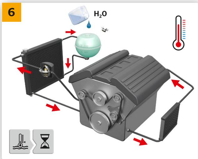
→ Rashladni krug napunite čistom vodom. Motor uz 2 500 o/min dovedite na radnu temperaturu i zatim ponovno ispusite vodu kako je opisano u radnim koracima 1 i 5.
