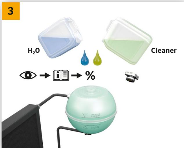
→ Čistu vodu pomiješajte u ispravnom omjeru miješanja s dodatkom za čišćenje (primjerice, MB A0009891025, Liqui Moly 3320, itd.) te ulijte u rashladni sustav.
