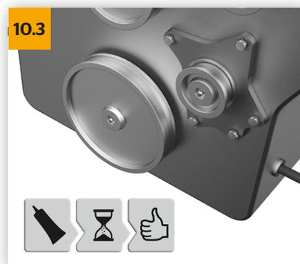
→ Brtvenu masu odnosno brtveno ljepilo upotrijebite samo ako su predviđeni isključivo za crpku za vodu. Kod crpki za vodu, koje se ugrađuju s takvim tekućim brtvilom, pazite na to da brtvilo naneseš te šteditljivo i ravnomjerno te se pridržavajte vremena sušenja prije nego što ponovno napunite rashladni krug. U suprotnom se rashladno sredstvo može onečistiti. Učvršne vijke crpke za vodu naizmjenice zategnite propisanim zateznim momentom.
