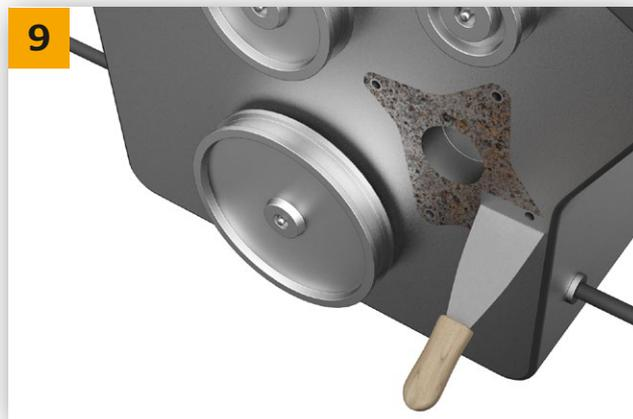
→ Zatim demontirajte staru crpku za vodu i temeljito očistite i odmastite sve brtvene površine.
