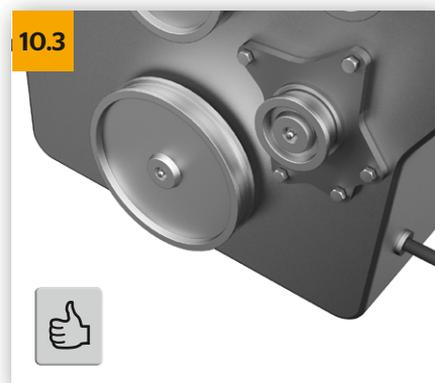
→ Ako je crpki za vodu priložena brtva ili ako je unaprijed montiran O-prsten, ne smije se upotrijebiti nikakva masa za brtvljenje! Unaprijed montirane O-prstenove prije montaže navlažite rashladnim sredstvom - nemojte upotrebljavati mast.
