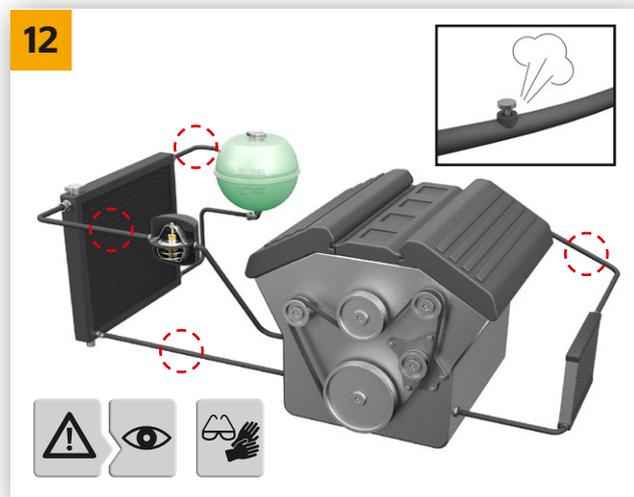
→ Rashladni krug odzračite u skladu s proizvođačevima uputama (po potrebi upotrijebite uređaj za punjenje) te provjerite nepropusnost. Moguće je kratkotrajno izlaženje male količine vode na otvoru za odvodnjavanje crpke za vodu.
