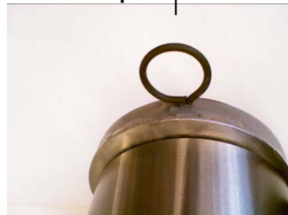
Fig. 3 Variante 2 - Dopo il montaggio della cinghia, estrarre la spina
