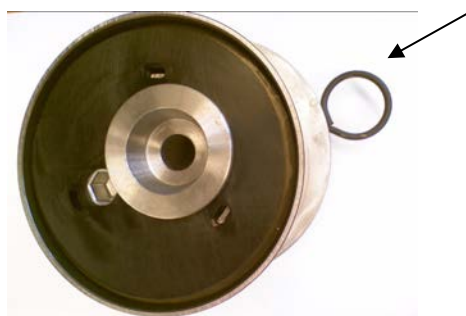
Bild 2 Spännrulle utan låsstift
