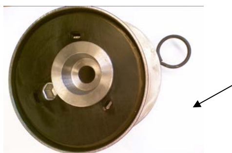
Rys. 2 Rolka bez pinu blokującego
