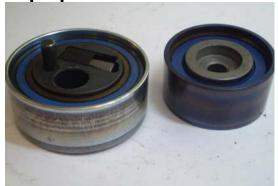
1. Отводной ролик механически блокирован (со стороны двигателя сверху)
