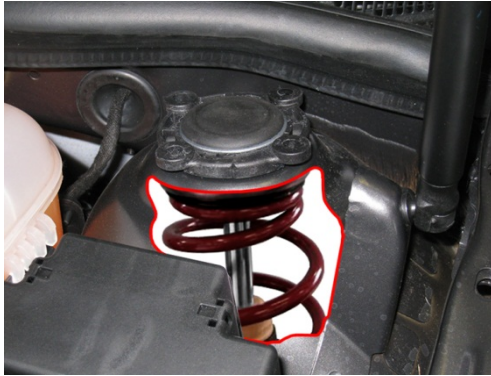
Abb./Fig. 1: Federbein mit Sicherungsring / Suspension strut with retaining ring / Jambe de force avec rondelle d'arrêt / Tubo amortiguador con arandela de seguridad / Gamba ammortizzatrice con anello di sicurezza
