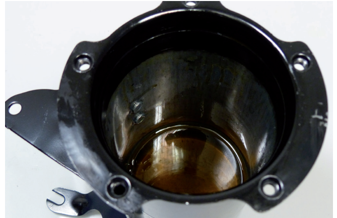
Εικόνα 2: Παλιό καύσιμο ντίζελ στο περίβλημα φίλτρου
