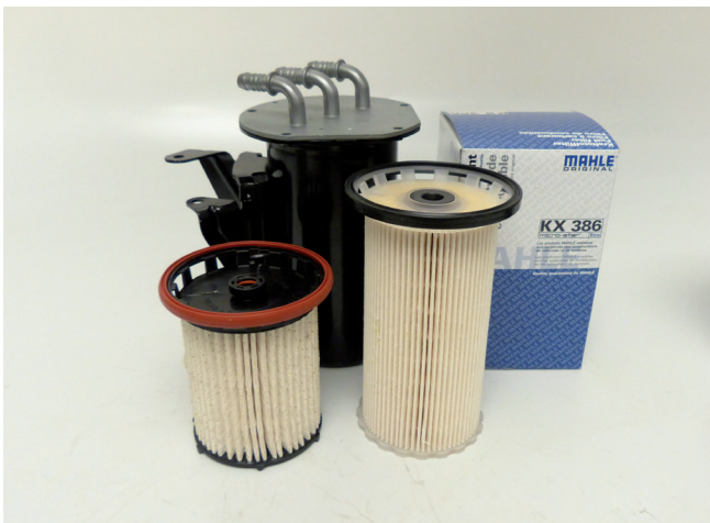
Εικόνα 1: Ένα περίβλημα - δύο πιθανά μεγέθη φίλτρου
