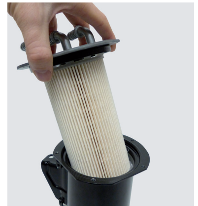
Εικόνα 3: Ανάλογα με τον τύπο κατασκευής, το φίλτρο θα πρέπει να στερεωθεί πρώτα στο καπάκι του περιβλήματος.
