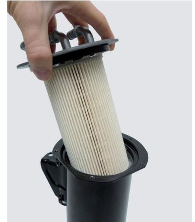
Resim 3: Tasarımına bağlı olarak, filtre ilk önce gövde kapağına tespit edilmelidir.
