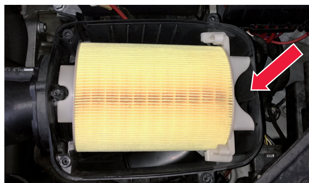
Zdjęcie 3: Drugi etap montażu – ząbienie wspomnianych dodatkowych zaczepów mocujących w obudowie
