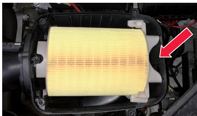
Figura 3: Paso 2 del montaje: enclavar los dispositivos de fijación
