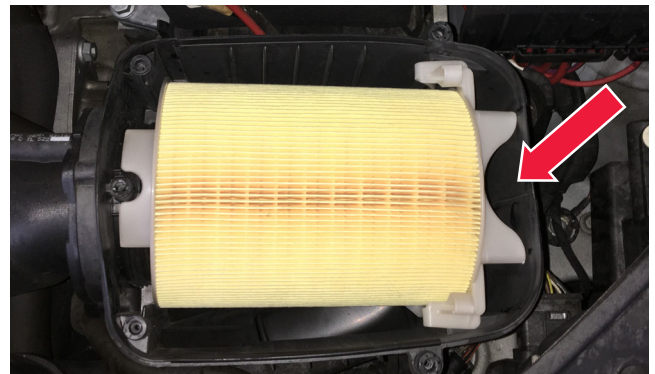
Abbildung 3: Schritt zwei der Montage – Fixierhilfen einrasten lassen
