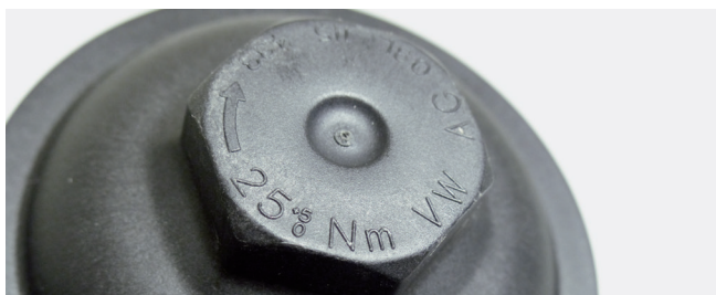
Figure 2 : Consignes de couple de serrage sur le couvercle de carter
