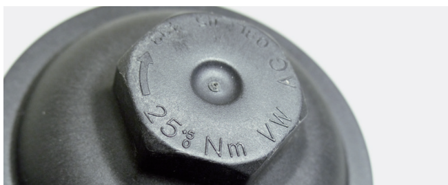
Ilustracja 2: Moment obrotowy podany na pokrywie obudowy
