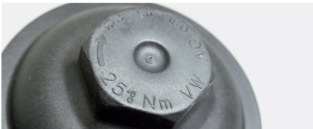
Εικόνα 2: Στοιχεία ροπής στρέψης στο κάλυμμα του περιβλήματος
