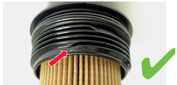
Figure 3 : Filetage en bon état
