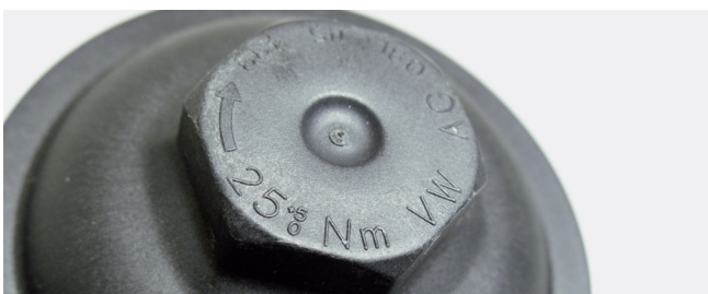
Abbildung 2: Drehmomentangabe auf dem Gehäusedeckel
