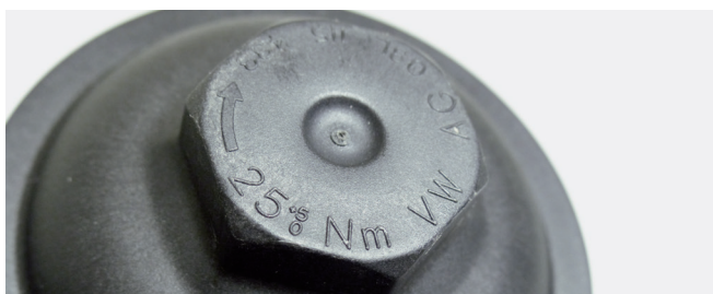
Figura 2: Indicación del par de apriete en la tapa del alojamiento
