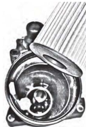
2. Dopo che l'asta è fissata inserire il filtro nell'alloggiamento.
