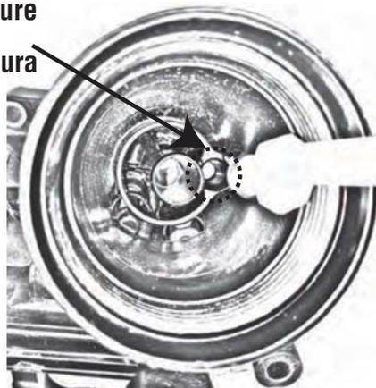
1. Insérez la tige en plastique dans le trou du boîtier et appuyez jusqu'à ce qu'il s'enclenche.
