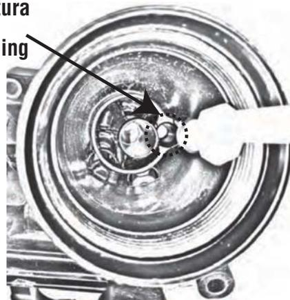
1. Inserire l'asta di plastica all'interno del foro presente nell'alloggiamento e premere fino ad incastro.
