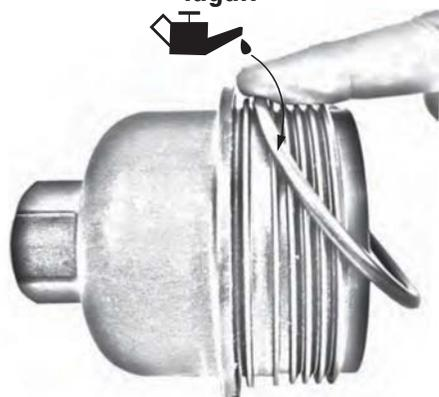
4. Placez le joint dans la fente spécifique du couvercle. Lubrifier le joint.
