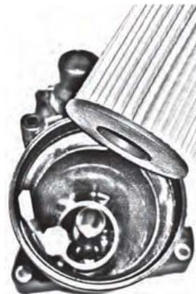
2. Une fois la tige attachée, insérez le filtre dans le boîtier.
