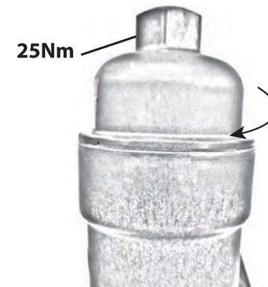
6. Premere e ruotare il coperchio in senso orario. Serrare applicando una coppia di 25Nm.
