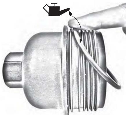
4. Posizionare la guarnizione nella fessura specifica del coperchio. Lubrificare la guarnizione.
