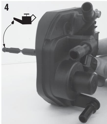
4. Appliquez une fine couche d'huile sur la barre de drainage pour insérer le joint torique sur le fond comme indiqué sur la fig.4.
