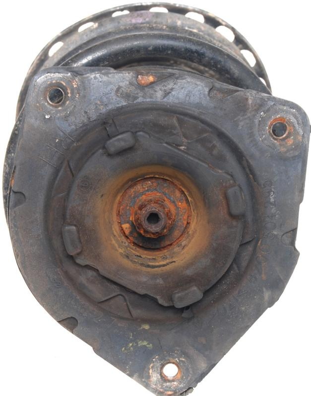
**Верхняя опора стойки на поздних моделях (после июля 2010):**
