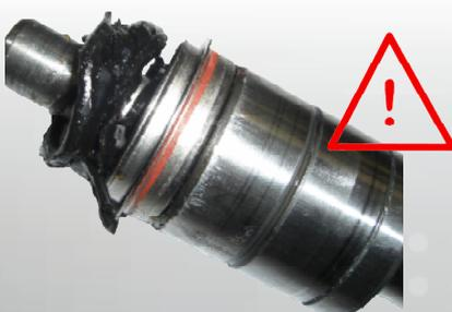
**Abb. 1:** Überschüssige Dichtmasse hat sich in der Gleitringdichtung abgelagert
