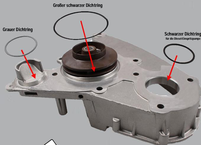
Für die Montage keine Dichtmasse verwenden!
