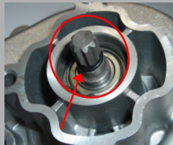
Die Verzahnung der Antriebswelle (siehe Foto) muss mit geeignetem hochwertigen und temperaturbeständigem Schmiermittel wie z. B. Molykote M77 oder gleichwertig versehen werden!
