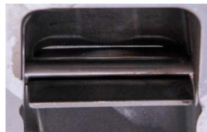
Schließt die Bypassklappe nicht vollständig, wird die Kühlung nicht optimal reguliert.
