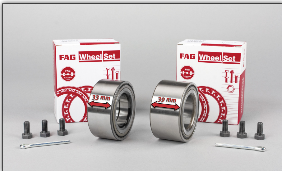
Figur 1: Bestillingsnr. 713 6702 20 (til venstre) har en bredde på 33 mm. Bestillingsnr. 713 6702 30 (til høyre) har en bredde på 39 mm.
