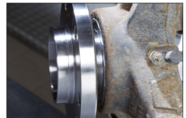
Figur 3: Låseringen skal ligge i flukt med styrespindelen
