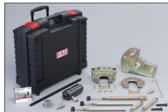
Foto2: 400 6199 10 – narzędzie specjalne jest wymagane do przeprowadzenia naprawy
