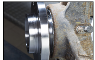
Foto3: 400 6199 10 – pierścień osadczy musi dokładnie leżeć w odpowiednim zagłębieniu zwrotnicy
