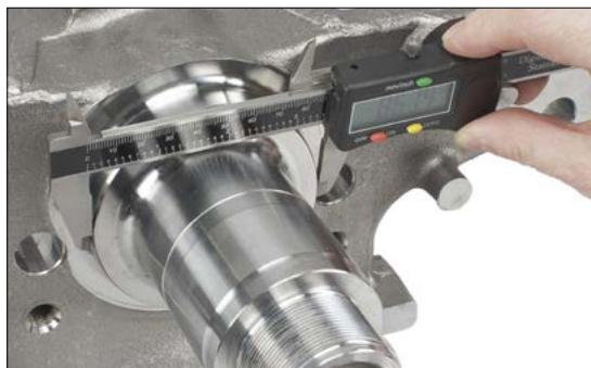
Figur 2: For å finne ut hvilken av de tre beskyttende ringene som skal installeres, må styrespindelens base måles.
