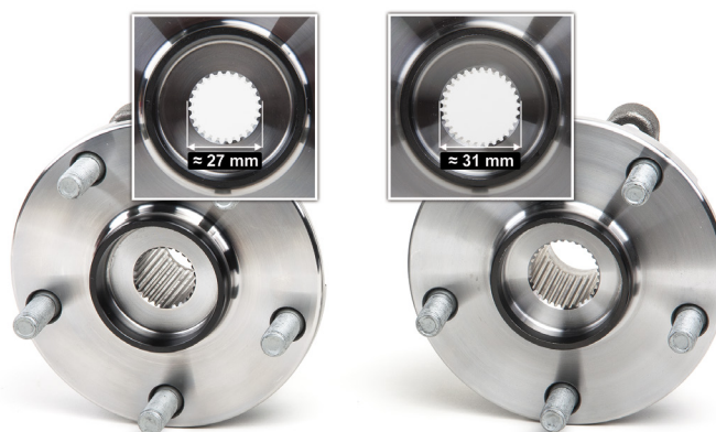
Foto 2: Różne wymiary wieloklinu przegubu
