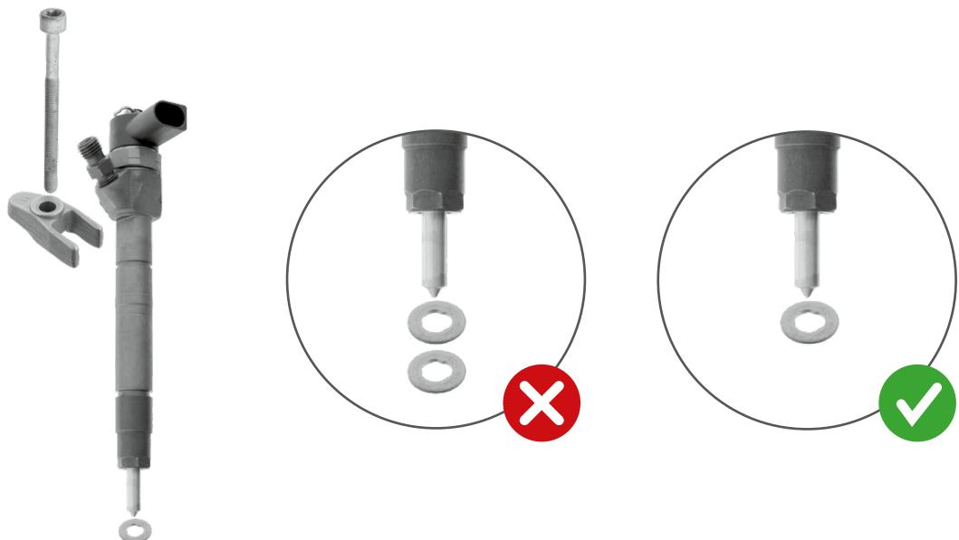
**NL** **Opgelet! Slechts EEN dichtring monteren, nooit beide dichtringen samen monteren!**
