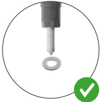
**DE** **Achtung! Verbauen Sie nur EINEN Dichtring, niemals beide Dichtringe gleichzeitig verwenden!**
