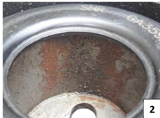
Il est donc très important de "clipser" le capuchon en plastique, qui assure l'étanchéité, sur le galet après le montage sur le véhicule (**Rep.3**), car la détérioration du roulement peut entraîner entre autre du bruit en fonctionnement.
