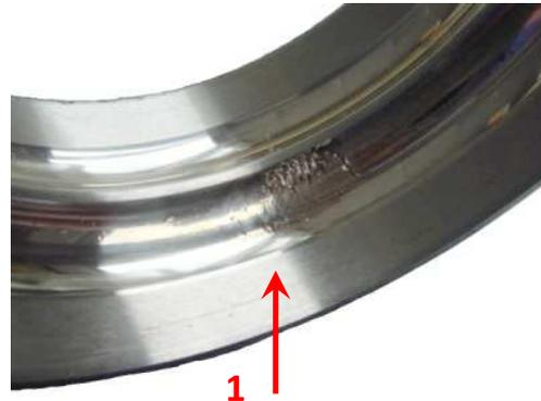
Der Einbau des Lagers verkehrt herum führt zu einer Fehlfunktion des ABS-Rechners (Fehlercode, ABS-Warnleuchte). Das Lager kann nicht ausgebaut und wiedereingesetzt werden. Bei der Montage des Lagers ist darauf zu achten, dass die Seite mit dem Magnetencoder getriebeseitig zeigt (d.h. zum Motor / Getriebe).
