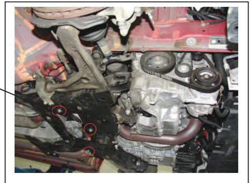
08. Kabelverbindungen an den Querlenkerlagern hinten trennen.
