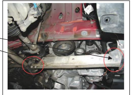
07. Schrauben vom Lenkgetriebe (3x) ausbauen und Lenkgetriebe gegen übermäßiges absinken sichern.
