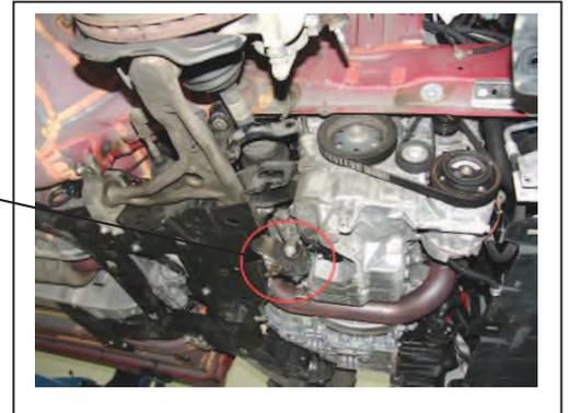
12. Schrauben VA Träger ausbauen und Träger etwas absenken!
