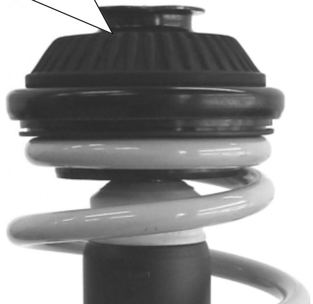
Nach erfolgtem Einbau des Fahrwerkes ist die Freigängigkeit der Bereifung zum VA Federbein zu überprüfen. Das Mindestabstandsmaß an der engsten Stelle darf **5 mm** nicht unterschreiten und ist gegebenenfalls mittels handelsüblicher, TÜV geprüfter Distanzscheiben wieder herzustellen.
