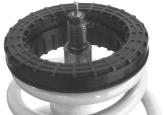
Original Domlager aufsetzen und mit der mitgelieferten Mutter verschrauben. Das Anzugsdrehmoment der Kolbenstangenbefestigung beträgt 50 Nm. Den Einbau des Federbeines entnehmen Sie bitte den Unterlagen des Fahrzeugherstellers.
