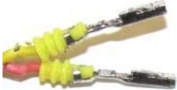
4. Steckersicherung öffnen. Fertig montierte Leitung mit Abdichtungen in das Gehäuse ganz einschieben und einrasten. Pinposition / Kabelfarbe ist nicht relevant. Anschließend Steckergehäuse verriegeln.
