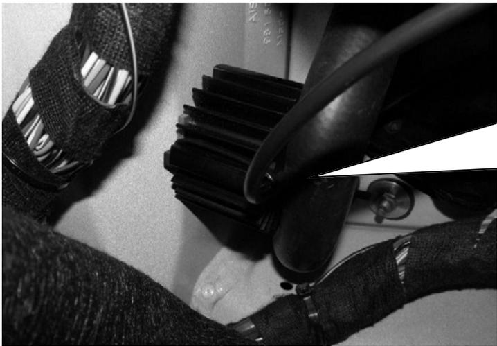
Elektronikbauteil auf den Fahrzeugrahmen kleben. **WICHTIG: Klebefläche muss Staub- und Fettfrei sein.** Originale Dämpfersteuerungsleitung in das Elektronikbauteil einstecken. Auf die korrekte Verriegelung des Steckers achten! **Leitung mit Kabelbindern befestigen.**
