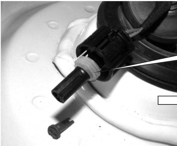
2. Rote Steckersicherung aus dem Stecker herausziehen. Originale Dämpferleitungen mit geeignetem Werkzeug aus der Stecker ausspinnen.
