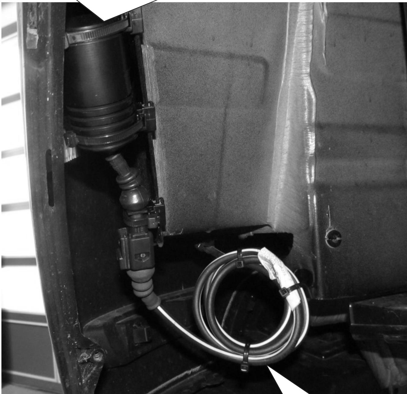
Original Kabel mit Kabelbindern befestigen.
