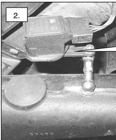
Der Einstellhebel des Sensors darf nicht nach oben gedrückt werden!
