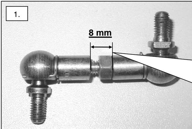
Zum Einstellen des Abstands die Kontermutter lösen und durch verdrehen des Kopfstücks den Abstand von 8 mm herstellen. Anschließend Kontermutter wieder festziehen.
