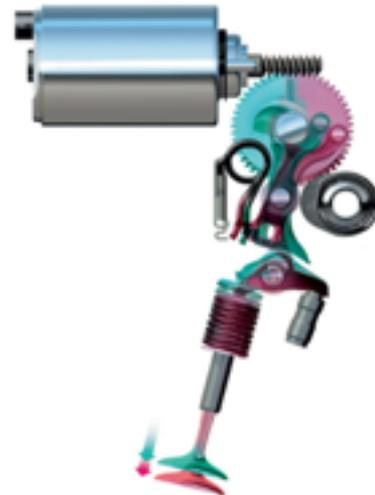
*Todas las **válvulas de admisión** están ligadas a un eje accionado por un motor eléctrico gestionado electrónicamente, que varía la posición del mismo según las exigencias del motor. Dependiendo de la posición en la que se encuentre dicho eje, la **palanca de accionamiento intermedia** apoyará de forma distinta sobre los balancines de las válvulas que se abrirán al recibir dicha palanca el movimiento del árbol de levas hasta una determinada altura para dejar paso a la mezcla.*
