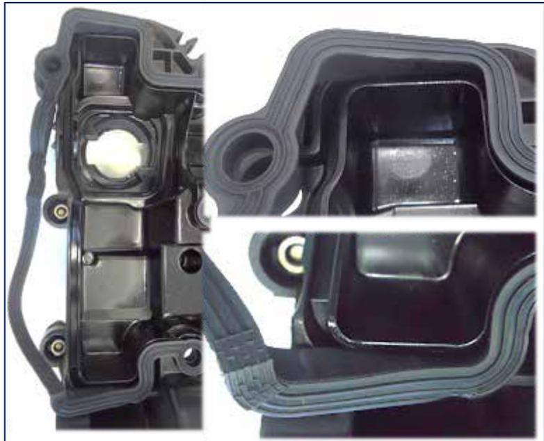
*Detalle de lo que sucede si intentamos montar la junta 11109300 en la tapa no correspondiente.*
