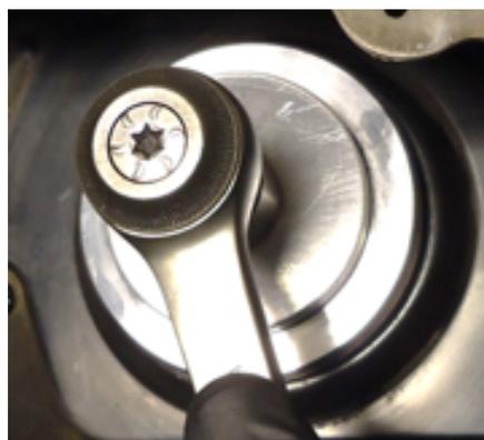
**6** Volver montar la polea del cigüeñal y la correa accesorio:
