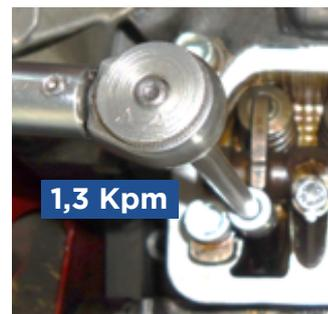
**3.** Apretar el tornillo de ajuste de nuevo hasta eliminar por completo la holgura entre el balancín y la válvula.
