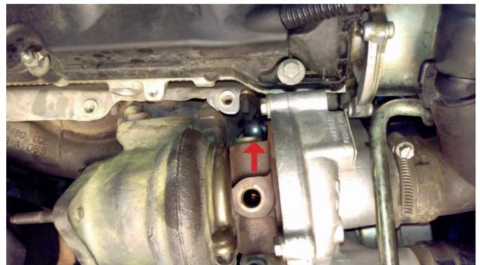
**9** Entre el turbocompresor y el bloque motor encontramos una pantalla térmica que cuenta con una aleta que protege el tubo de engrase del calor emitido por el colector de escape. **Durante el montaje debemos cerciorarnos de que el tubo de engrase quede a la derecha de dicha aleta.**
