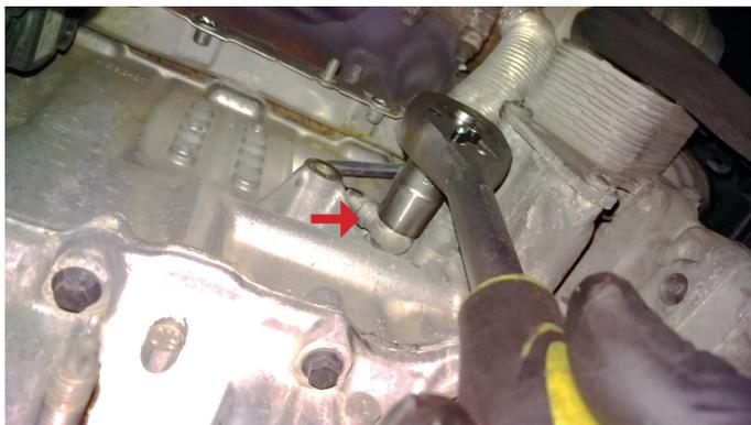
El **tubo** debe ser **instalado por la parte baja** del turbo, introduciéndolo entre el turbo y bloque motor.
