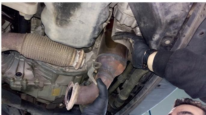
**6** Retirar el soporte inferior del turbocompresor, sujeto mediante 2 tornillos, y la pantalla térmica posterior, unida al bloque en su parte alta mediante 2 tornillos.
