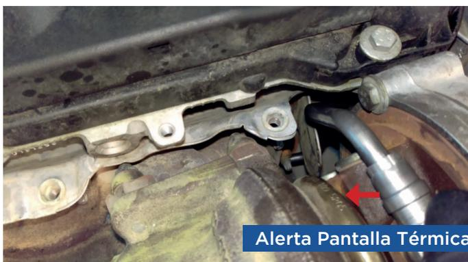
Una vez posicionado, **colocar en primera instancia el racor de la parte superior con el turbocompresor**, sin llegar a aplicar el apriete, para colocar posteriormente el racor inferior con el bloque motor. **Utilizar en ambos racores las arandelas de cobre suministradas**, colocándolas a ambos lados del banjo.
