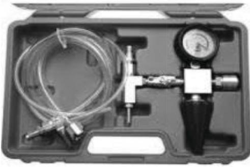
Pour toute intervention effectuée sur le circuit de refroidissement, il faut impérativement purger celui-ci avec **un purgeur à vide standard**. Cela permettra d'éviter les moindres bulles d'air, afin de ne pas provoquer de surchauffe du moteur.
