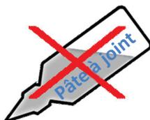
La lèvre du joint torique étant étanche, aucune pâte à joint supplémentaire ne doit être utilisée! Afin de maintenir le joint torique en position, un lubrifiant sans acide approprié peut être utilisé.
