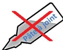
Pour le joint torique rond, aucune pâte à joint supplémentaire. Des lubrifiants sans acide comme la vaseline doivent être utilisés ou humidifier le joint avec du liquide de refroidissement
