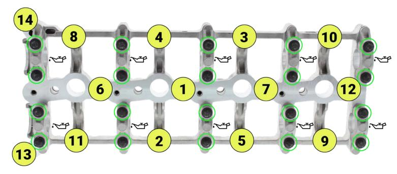
Vor dem Einbau jeder Nockenwelle ist es unbedingt erforderlich, die Kanäle zu schmieren. Diese Vorgehensweise vermeidet jegliche Reibung des Metalls auf Metallkomponenten bei erster Inbetriebnahme.
