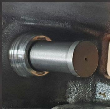
Ora il tenditore può essere montato sulla testata e si innesterà completamente. Dovrebbe essere serrato ai 70Nm raccomandati.
