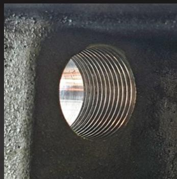
Utilizzare un utensile per filettatura M22 x 1,5 mm per rimuovere accuratamente eventuali sbavature / contaminazioni all'interno della filettatura della testata.
