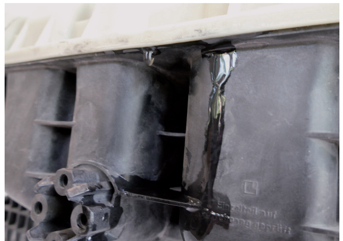
Figura 3: El refrigerante rebosa y vuelve a salir por la zona de la junta del depósito de expansión
