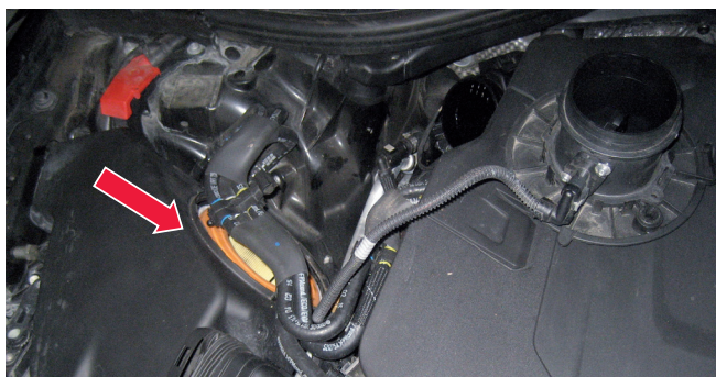
Figure 1 : Positionnement du filtre à air sur un moteur V6 3.0 TDI
