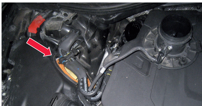
Figura 1: Posición de montaje de un filtro de aire en un motor V6 3.0 TDI
